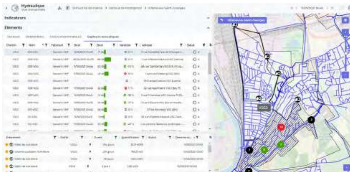
Extrait du tableau de bord Aquadvanced pour la recherche de fuites fixe et débitmètres de sectorisation.
